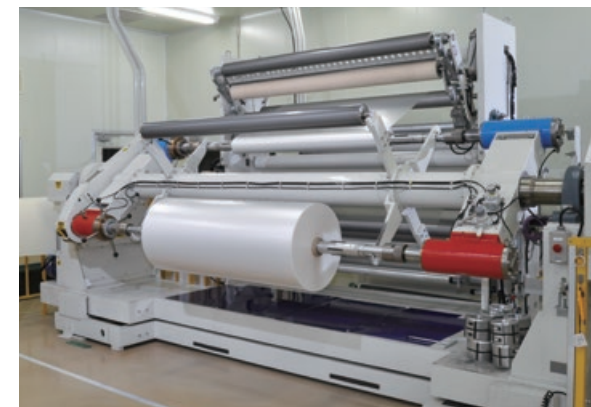
塗工装置 大型機仕様 | 大型機は1パスで背面剤・プライマー剤・主剤の3種塗工が可能。コスト削減のお役に立ちます。(最大有効幅:1800mm)
