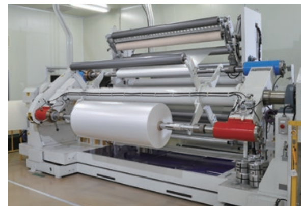
塗工装置 大型機仕様 | 大型機は1パスで背面剤・プライマー剤・主剤の3種塗工が可能。コスト削減のお役に立ちます。(最大有効幅:1800mm)
