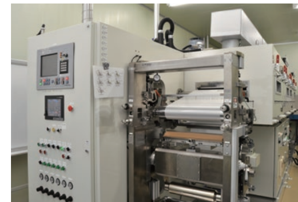
塗工装置 小型機仕様 | インラインラミネーターを備えた小型機では、開発案件・少量試作にも対応します。(最大有効幅:450mm)
